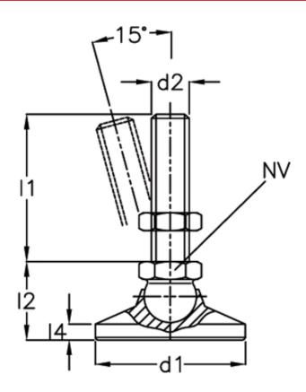
d1 = 50 Static load = 23 d2 = M10 Weight in (g) = 222 11 = 80
